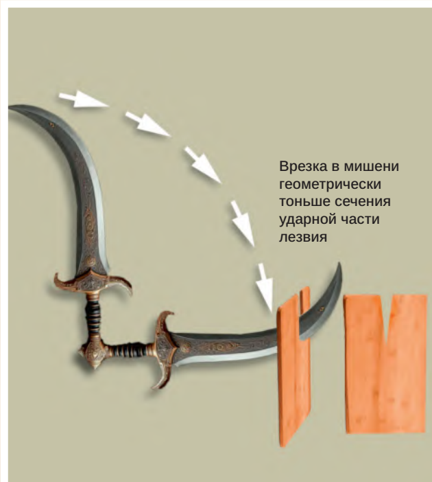
Схема № 3: нанесение рубящего удара кривым клинком
