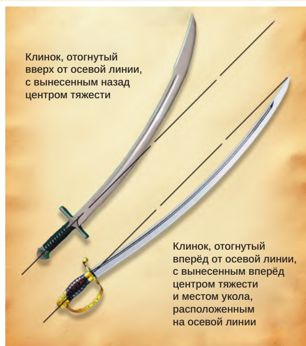
Схема № 4: размещение клинков относительно осевой линии оружия
