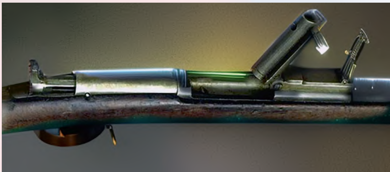
Винтовка Бердана № 1 с откидывающимся вверх затвором образца 1868 года
