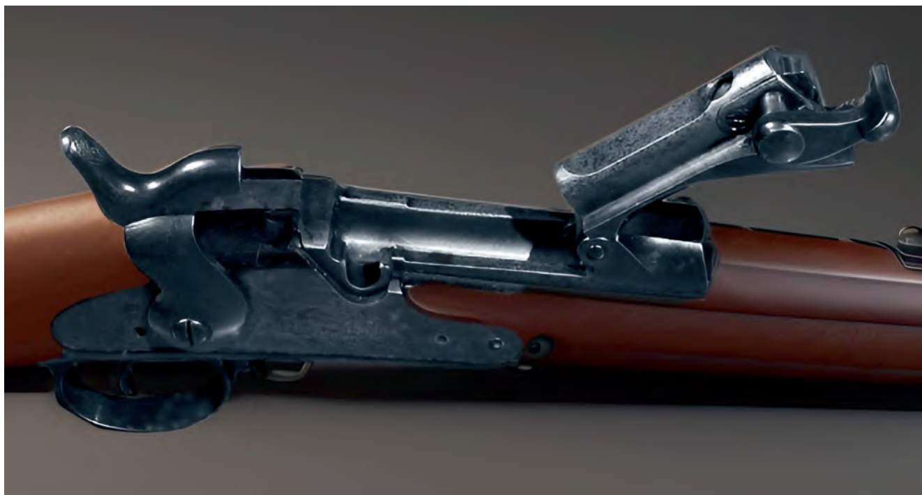
Откидной затвор Бердана «Trapdoor»
