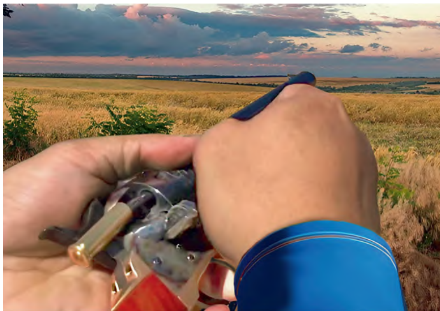
Экстрактирование стрелянных гильз в кольте «Опен Топ»
